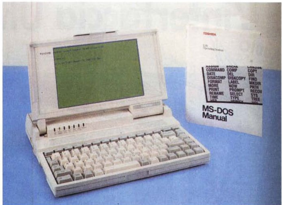
Il Toshiba T1000SE, nonostante fosse basato su un 80C86 e di un solo floppy (niente HD), costava quasi di tre milioni di lire, ma rese felice molti suoi possessori.
